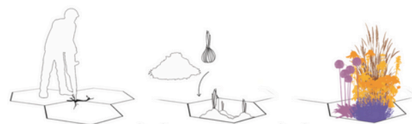
Vorgehen der Pflanzung: Aufbrechen des Asphalts in Wabenform. Befüllen der Pflanzgruben mit Substrat und Pflanzen. Nach einer Weile entsteht ein buntes Blütenmeer im vorher grauen Asphalt.
